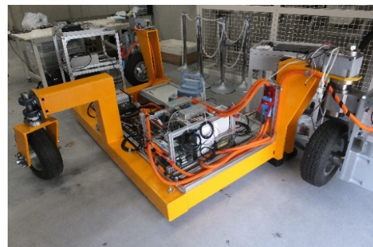
▲ 統合制御ユニットを実装した評価用搬送機器
