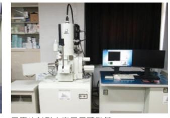
電界放射型走査電子顕微鏡
